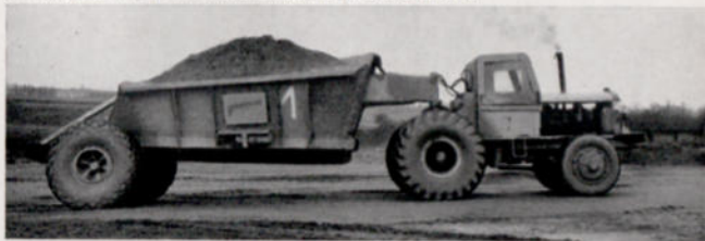
26 Tonnen Schüttgut faßt dieser amerikanische Bodenentleerer.
