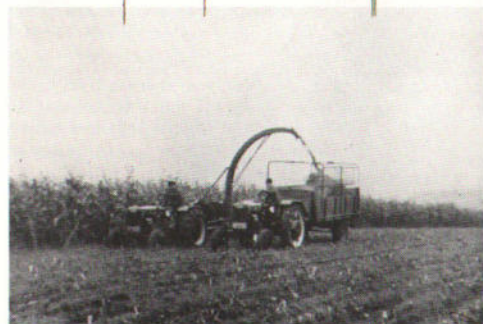
McCORMICK-Feldhäcksler mit Reihenerte-gerät für die Ernte von Mais, Topinambur etc.
