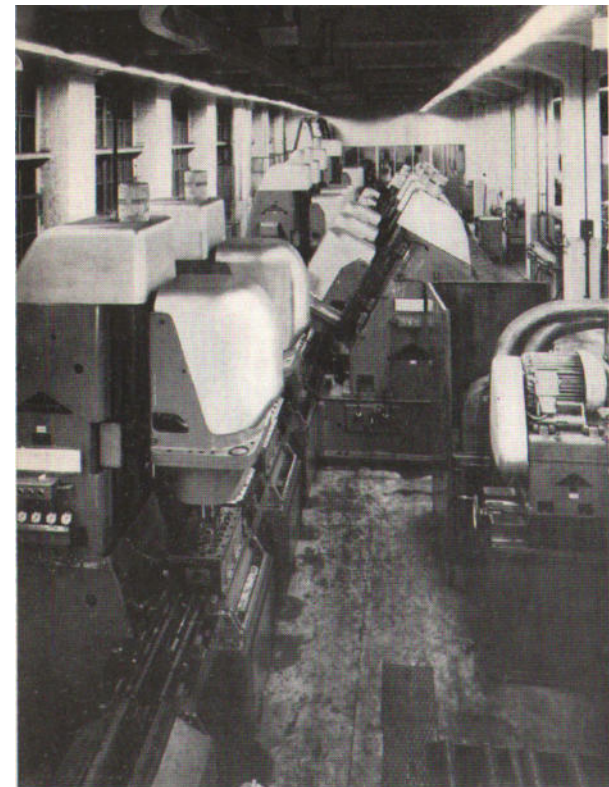
Gesamtansicht der Transferstraße. Im Vordergrund links ist die Gleitbahn mit Transporteinrichtung und ein Zylinderkopf zu sehen, der beim nächsten Verschieb in die erste Vorrichtung gelangt. Auf der ersten Station werden die Ventiltälte vorgebohrt.
