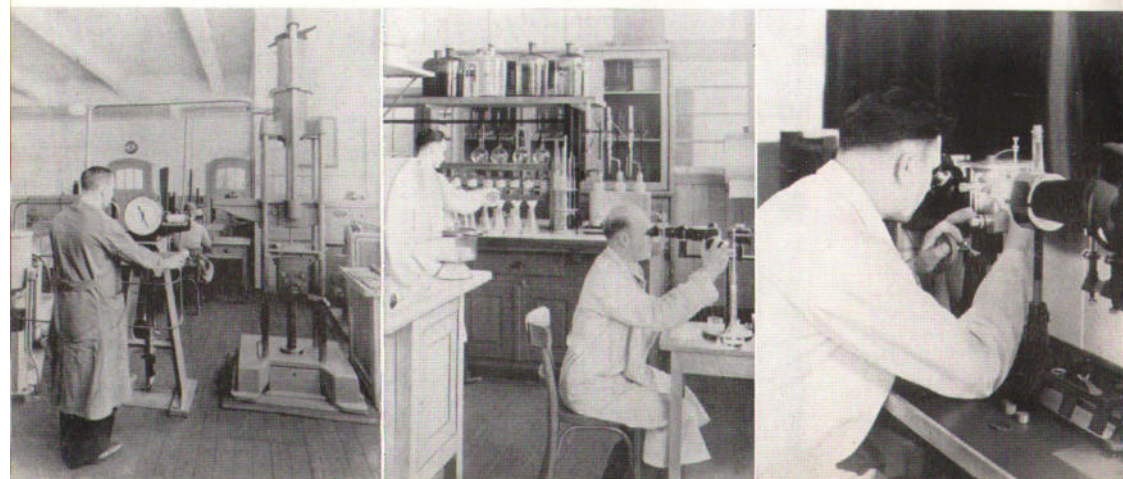
Festigkeitsprobe mit einer 30 t Zerreißmaschine
