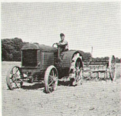
„Der Großvater“, ein alter IHC-Schlepper vom Typ 10/20 muß manchmal noch mit eingesetzt werden. Er springt heute noch auf Antrieb an.
