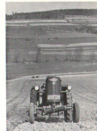
Die zusätzlichen Gewichte an der Vorderachse erwiesen sich bald als überflüssig, da der FARMALL selbst an den Stellen mit mehr als 20% Steigung vollkommen sicher lag.
