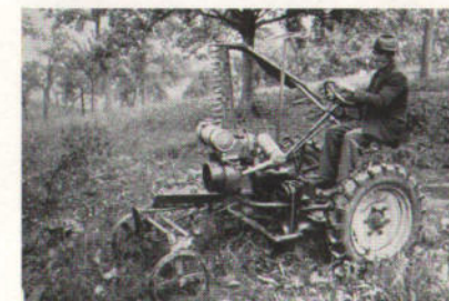
Ein Hindiger Kopf im Münchener Gebiet hat seinen IH-Gespanntrasmäher motorisiert und mit Hilfe des Vorderwagens lenkbar gemacht. Keine Ideallösung . . . aber originell!
