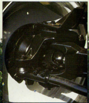
Integrierter Frontkraftheber/ Frontzapfwelle (Sonderausrüstung)
