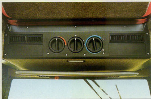
Drehschalter für Heizung und Klimaanlage
