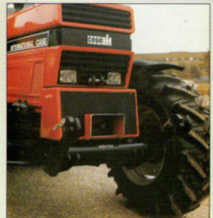
Integrierter Frontkraftheber/ Frontzapfwelle (Sonderausrüstung)
