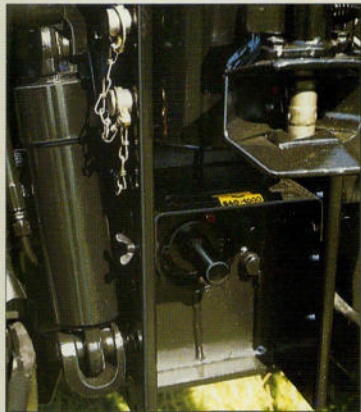
Lastschaltbare Zapfwelle, 540 und 1000/min
