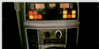
Digitalanzeigen sind gut im Blickfeld über dem Lenker angeordnet.
