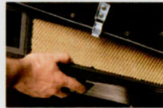
Der Filter für die Hochleistungs-klimaanlage ist mit wenigen Handgriffen auszuwechseln.
