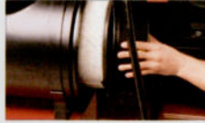
Der Hauptluft-Filter ist leicht zugänglich. Ein zweiter, innen angeordneter Filter dient als Ersatz bei Ausfall des Außenfilters.
