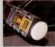
Seriennäßig: Radarsensor für echte Geschwindigkeitsmessung und Schlupfkontrolle
