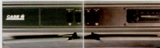
Integriert in die Dachkonsole: Bedienelemente für Innen- und Außenbeleuchtung, Scheibenwischer sowie Radio und Kaltstarteinrichtung.
