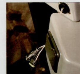
Zusätzliche Elektroanschlüsse an verschiedenen Stellen des Fahrerstands
