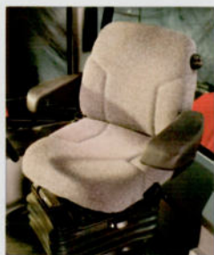
Der luftgefederte, rückenfreundliche Case IH-Komfort-Sitz ist nach rechts und links drehbar.
