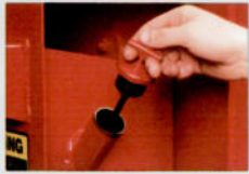
Auch der Peilstab zur Überprüfung des Getriebeöls ist einfach zu erreichen.
