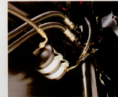
Die gut zugänglichen Hydraulik- und Getriebeöl-Filter brauchen nur alle 1500 Stunden oder einmal jährlich ausgetauscht zu werden.
