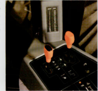
Full PowerShift, schalten ohne Kuppeln und ohne Kraftfluß-Unterbrechung.
