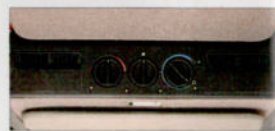
Drehschalter für das Heizungs- und Belüftungssystem befinden sich in der Dachkonsole.
