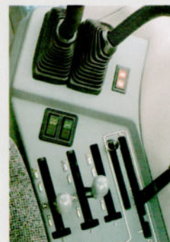
Einschaltung von Allradantrieb und Differentialperre per Knippschalter
