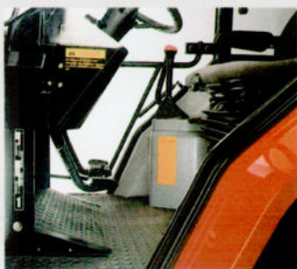
Ebener Kabinenboden, hängende Pedale
