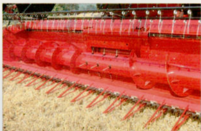
Einzugschnecke mit großem Durchmesser und hohen Windungen.
