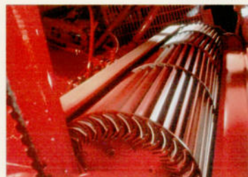
Patentiertes Querstromgebläse Cross Flow®.
