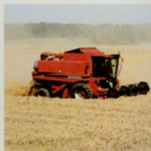
Der Axialfluß-Mähdrescher erlaubt hohe Arbeitgeschwindigkeiten bei geringsten Verlusten.
