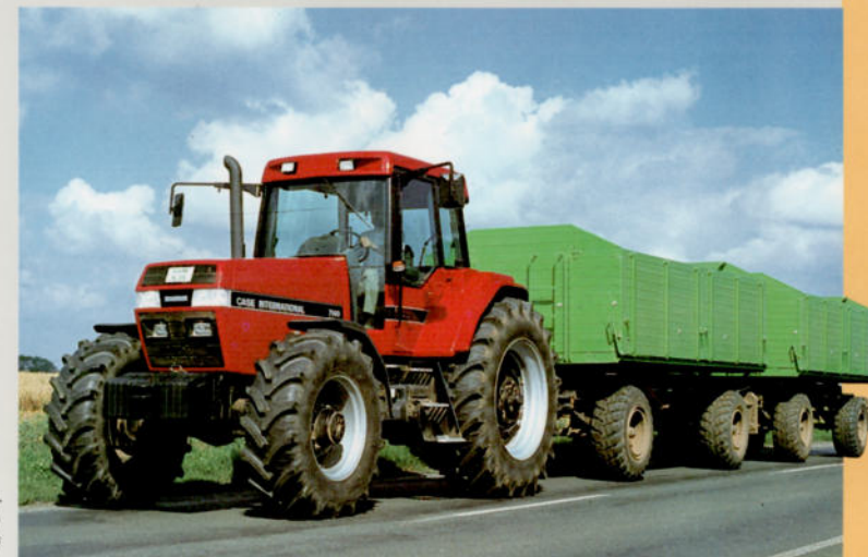
Der Magnum 7140, hier im Bild in der 40 km/h-Version, leistet 181 kW (246 PS) und verfügt über ein voll lastschaltbares Powershiftgetriebe mit 24 + 6 Gängen.
