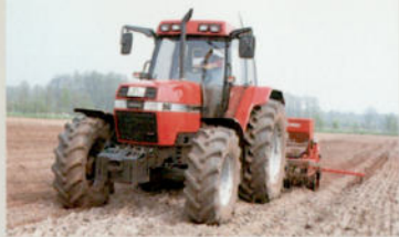
Schleppertechnik vom Feinsten bietet der MAXXUM PLUS. Beispiel: Das 4x4 stufige Lastschaltgetriebe und das lastschaltbare Wendegetriebe mit Neutralstellung.
