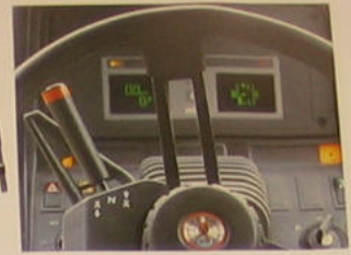
Oben: Vorwärts-rückwärts-Lastschalt-Wendehebel mit Neutralstellung
