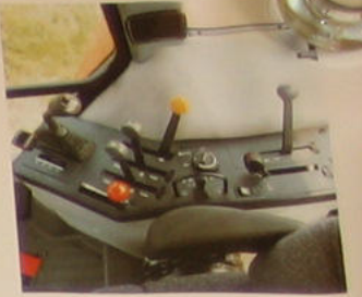
Oben: Vorwärts-rückwärts-Lastschalt-Wendehebel mit Neutralstellung
