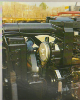
Kompressor der Klimaanlage
