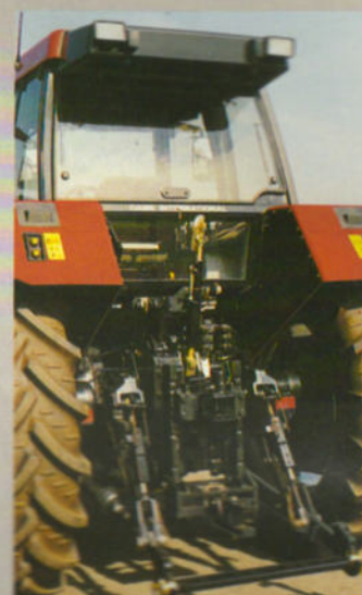
Schlepperheck und Kraftheber in deutscher Standardausführung
