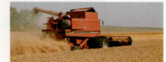
5,9 und 8,3 l-CASE-Motoren Rotierendes Kühlluftsieb am Heck Hydrostatisches Getriebe Hydraulische Scheibenbremsen
