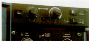
Steuergerät für Hangparallelerstellung
