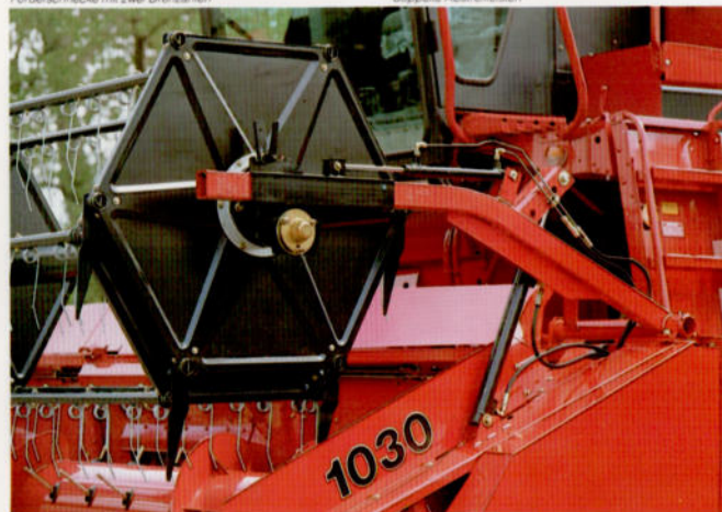
Hydraulische Höhen- und Horizontalverstellung der Haspel
