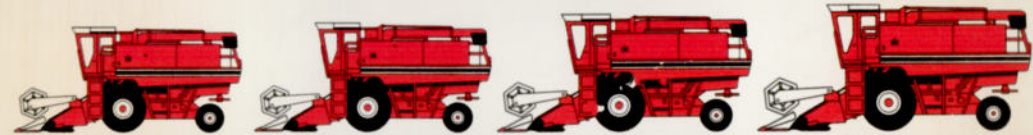
AF 1420 Schnittbreite 3,10 m, 3,70 m AF 1440 Schnittbreite 3,70 m AF 1460 Schnittbreite 4,30 m, 4,90 m AF 1480 Schnittbreite 4,90 m
