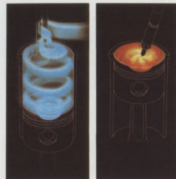
Ansaugtakt und Direkteinspritzung in die Brennraummulde.
