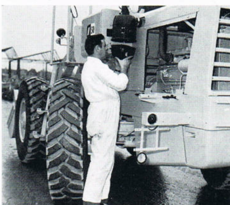
5 Die Brems hydraulikzylinder und der Druckluftbehälter können durch diese Öffnung einfach gewartet werden.
