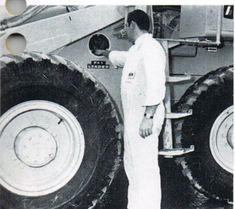
5 Die Brems hydraulikzylinder und der Druckluftbehälter können durch diese Öffnung einfach gewartet werden.
