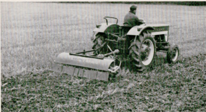
McCormick-Schlepper 423 – 40 / 42 PS – mit Rotorkrümler RKB-SG 372 Arbeitsbreite 1,65 m Umdrehungszahl der Arbeitswalze 145 oder 228 in der Minute
