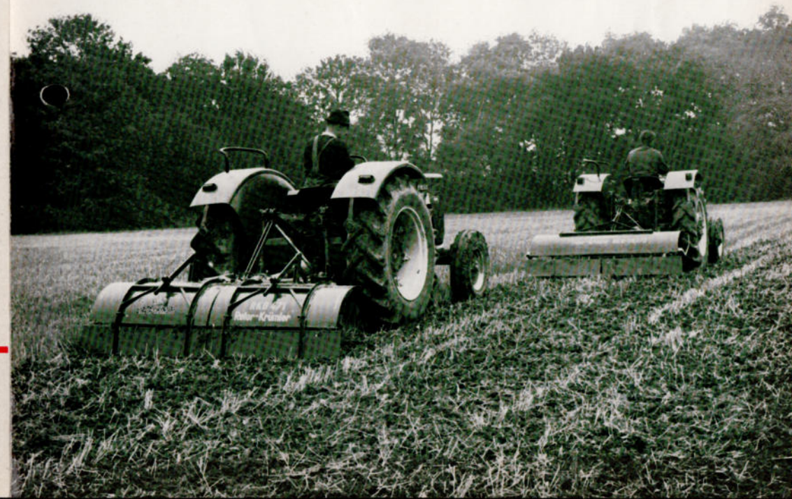
Hier ein Beispiel für einen asymmetrischen Aufbau eines Rotorkrümlers (IH RKB 272 und IH RKB 372). Hierdurch ist es – auch bei breiterer Schlepperspur – möglich, über die Spur eines Hinterrades hinweg- zuarbeiten. Druckschäden werden also immer vermieden. Auch die Arbeit in Obstplantagen wird so vereinfacht und Schäden durch zu nahes Fahren an den Baumreihen sind ausgeschlossen.
