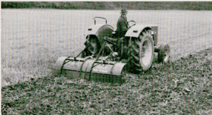
McCormick-Schlepper 624 – 58 / 61 PS – mit Rotorkrümler RKB 471 Arbeitsbreite 2 m Umdrehungszahl der Arbeitswalze 186 in der Minute
