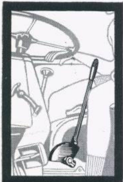
Agriomatic - Hebel ist wieder nach hinten gelegt - Neutralstellung.
