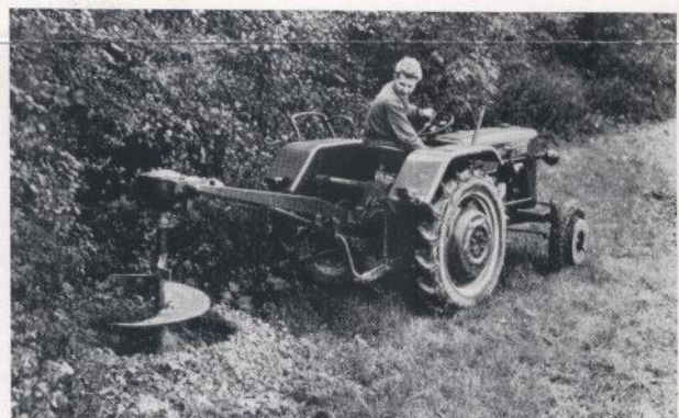
McCormick International Erdbohrer für Dreipunktaufhängung, ein guter Helfer zum Setzen von Koppelpfählen und Pflanzen von Obstbäumen.
