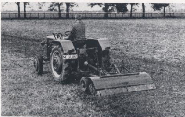
McCormick International Anhänge-Rotorkrümler, für die Saatbettbereitung, zum Schollenzerkleinern, zum Schälen und zum Einarbeiten von Stallmist.
