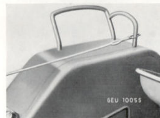
Bild 2a: So wird das Zugseil am Schlepper befestigt
