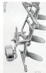
Bild 9: So ist das Stützrad zum Schälrahmen richtig angebracht
