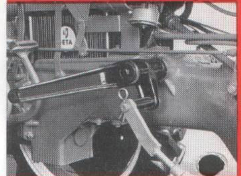
Die mittlere Hubwelle mit Lastarmen macht die hydraulische Bedienung von Zwischenachsgeräten möglich.
