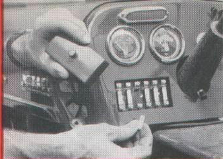
Vom Fahrersitz aus kann die Kontrolle der elektrischen Anlagen wie auch das Auswechseln der Sicherungen unternommen werden.
