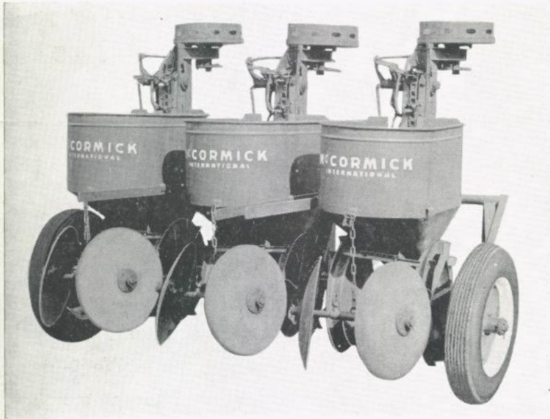
Dreireihige Kartoffellegemaschine für Schlepperzug, Gewicht ca. 430 kg, Fassungsvermögen 225 kg, verstellbare Spurweite, mit Gummibereifung
