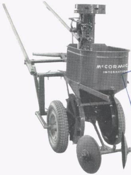
Einreihige Kartoffellegemaschine für Gespannzug, Gewicht ca. 200 kg, Fassungsvermögen 75 kg, verstellbare Spurweite, mit Gummibereifung.
