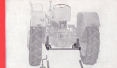
Der Normschwingrahmen ist mit hydraulischem Kraftheber, als festgestellter Zugrahmen oder mit Spindelverstellung vielseitig verwendbar.
