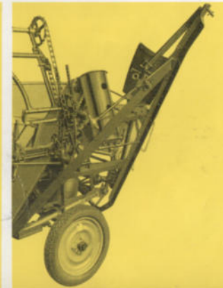
Die Maschine in Transportstellung mit hochgeklappten Zugrahmen.
