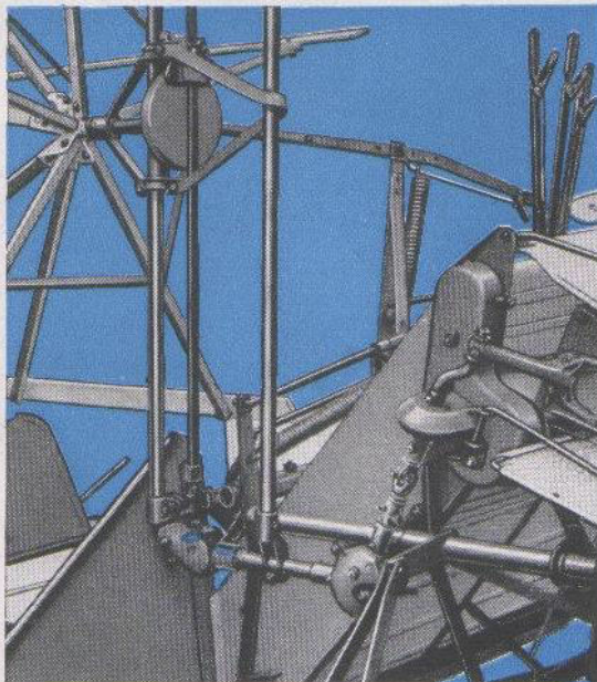
Elevatorgetriebe und Haspelgetriebe sind durch Kapselung vor Wickeln und vorzeitigem Verschleiß geschützt.
