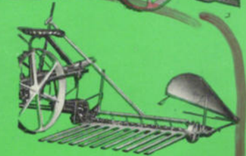
M c CORMICK-DEERING- Handablage zum Getreidemähen. Sie ist mit wenigen Handgriffen anzubringen und wieder abzunehmen. Der Lattenrost wird mit dem link. Fuß bedient.
