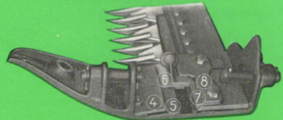
Die vortreffliche Messerführung am Innenschuh: (4) vordere Messerkopfkappe, (5) Bodenplatte, (6) Messerkopfplatte, (7) Reibungsplatte, (8) Hintere Messerkopfkappe
