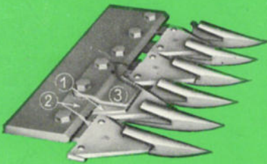
Die patentierte Messerführung (DRP 637572 u. 653803): (1) Reinigungsplatte, (2) Reibungsplatte, (3) Messerhalter
