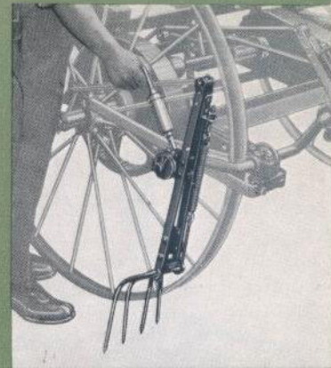
Zuverlässige und bequeme Fettpressenschmierung für alle Lagerstellen.
