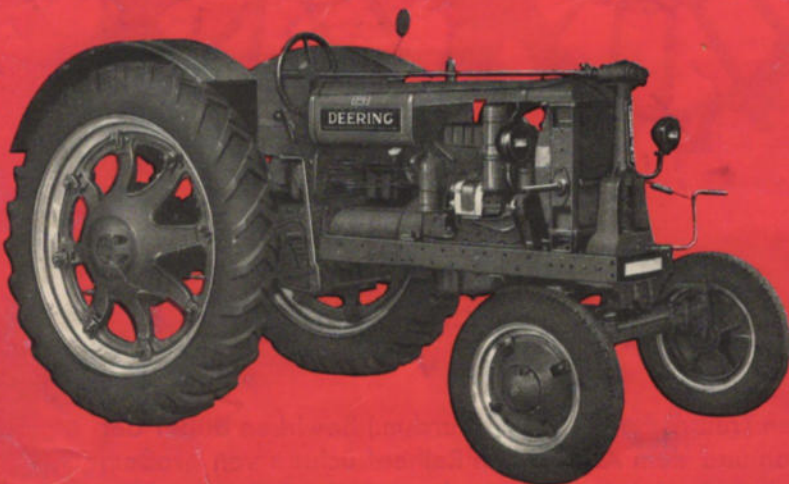
DEERING Schlepper „FG“ Reifenausrüstung: vorn 5.00 x 16, hinten 9.00 x 40
