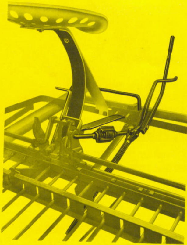
Ein gut gefederter Sitz (DRGM. 1359 286) und eine bequeme Fußrast sind Annehmlichkeiten, die jeder Fahrer zu schätzen weiß
