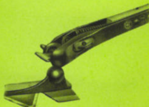
Das Schließen der Verbindung zwischen Treibstange und Messer- kopf erfolgt ohne jedes Werkzeug
