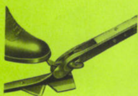
Durch Fußdruck wird der Verschluß ganz geöffnet. Die Treibstange kann nun bequem abgehoben werden
