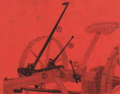
Der praktische Aufzughebel und das vollkommene Aufzugwerk. A Drückerloser Aufzughebel, B Drückerloser Räderhebel, C Räderhebel, D Auslöser, E Hilfshebel, F Anschlag des kombinierten Aufzugwerkes
