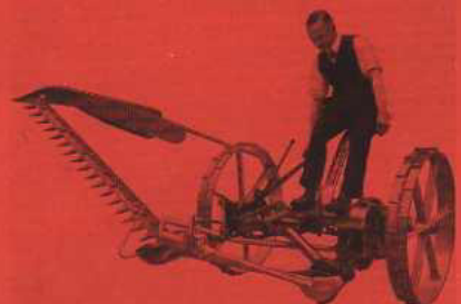
Höchste Stellung des Schneidebalkens bei einfachem Aufzug. Unter dem Innenfuß ist ein hoher Durchloß
