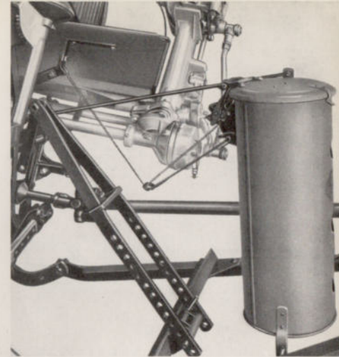
Die Bindegarnzuführung vor der Binde-nadel ist geschützt. Ein federnder Fadenspanner hält das Garn immer straff.
