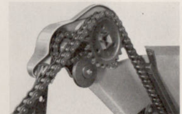
Schwere Qualitäts-Rollenkette für den Elevatorantrieb.
