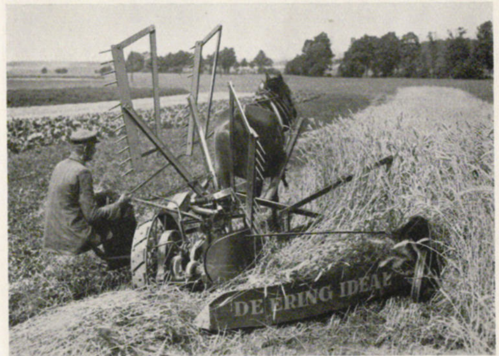
DEERING Getreidemäher Nr. 1, Leichtes Modell 4' (ca. 1,22 m) Schnittbreite, als Einspänner.
