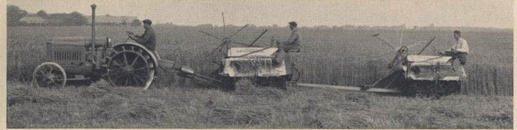
MCCORMICK Traktor mit direkt gekuppeltem Zapfwellenbinder und angehängtem zweiten (Pferdezug-)Binder
