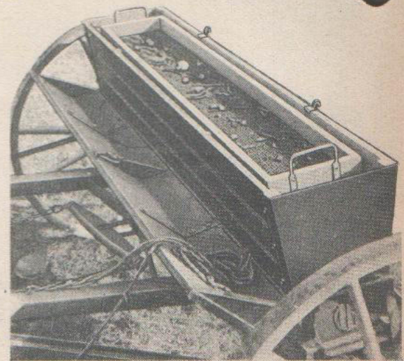
Aufsatzkasten mit herausklappbarem Kalksieb
