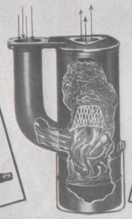
Luftreiniger mit Oelfilter
