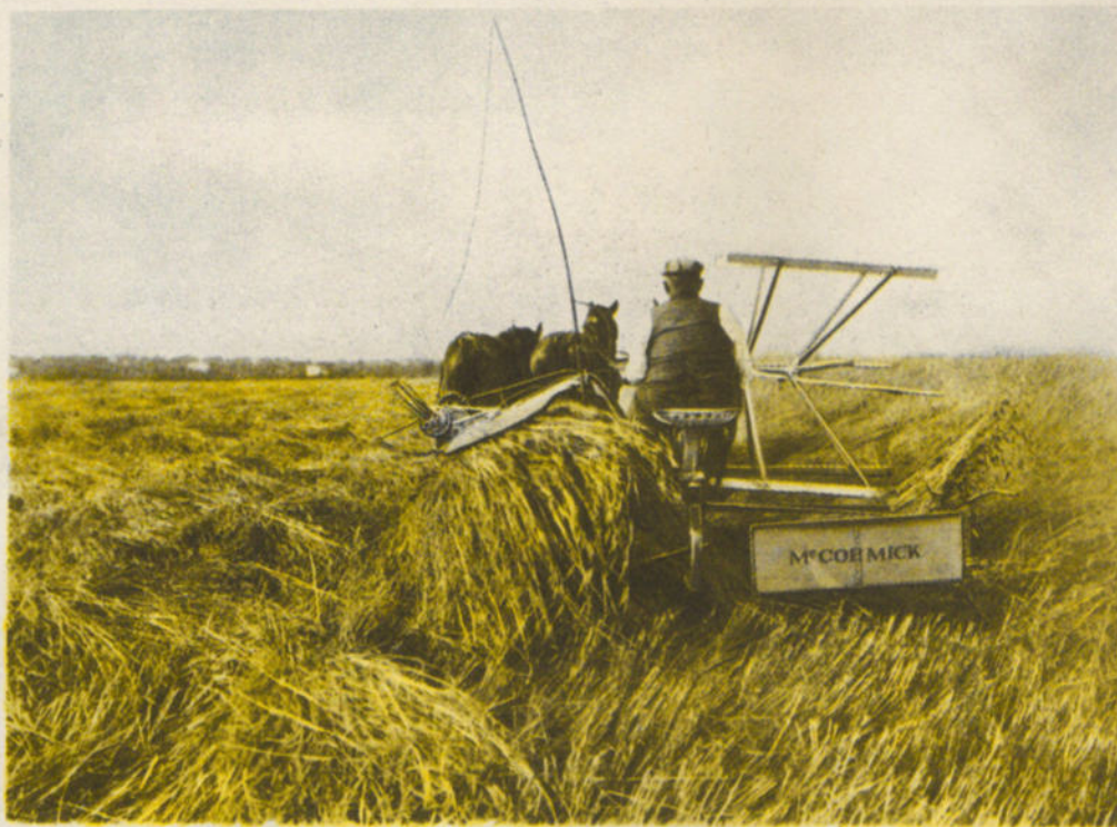
M C CORMICK-Garbenbinder, 5 Fuß rechtsschneidend, mit I. H. C.-Ährenhebern stark lagernden, langen Roggen mähend.
